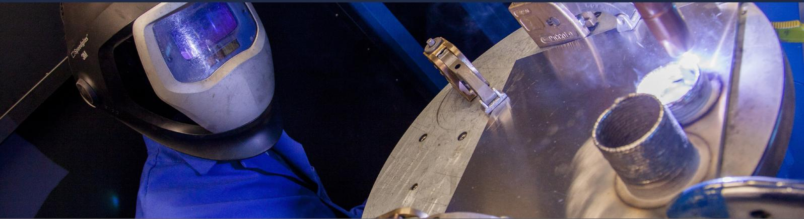
*La technologie WAAM nous offre de nombreux avantages : la possibilité de construire des pièces de grandes dimensions et réduire nettement les temps de production (le taux de dépôt est élevé) ; des coûts machines et les coûts de production plus faibles que ceux obtenus avec les autres procédés de fabrication additive (EBM, SLM) ; une importante variété de nuances de matériaux en fil.*
